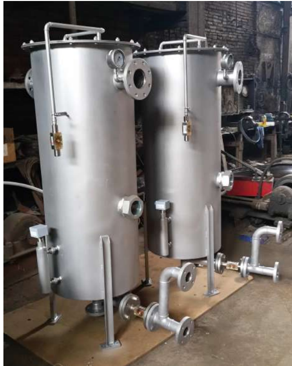
Figura 5. Sistema de eliminación de humedad y espuma en el biogás.
